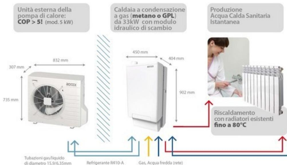
L' Hybrid System può essere allacciato direttamente all'impianto di riscaldamento esistente, senza intervenire sui radiatori e sul sistema di distribuzione presenti. **Bassi costi di installazione e facile intervento.**
